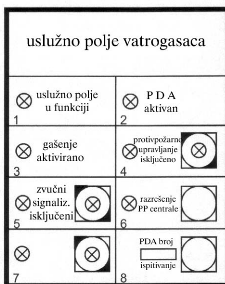
Slika 40 : montaža skice ( mere prema DIN 14661 )
