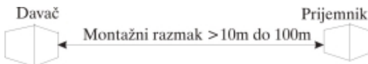
Slika 24 : Trajna vidljiva veza između davača i prijemnika
